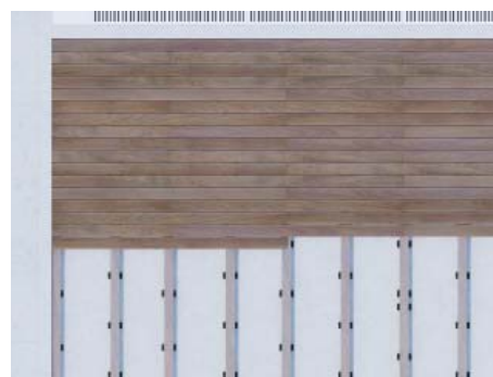
figura D - posa corretta: il montaggio procede per file, con un disegno a tolda di nave sfalsata.
