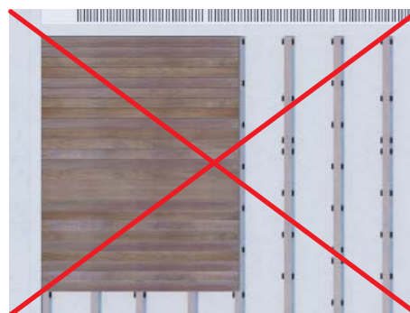
figura E - posa errata: il montaggio procede per colonne.
